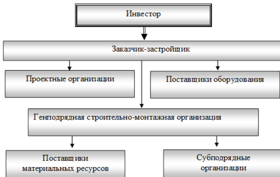
Рис. 4. Схема организации инвестиционного процесса строительного производства [9, с.49]
