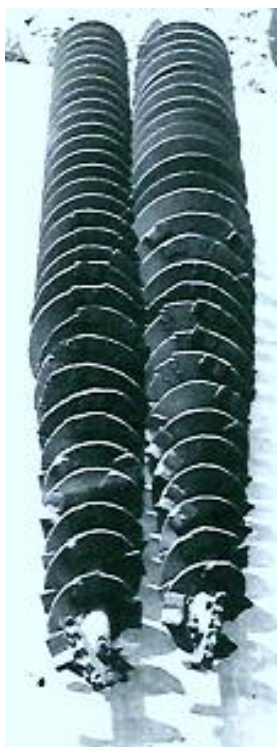
Рис. 2. Ставы (шнеки) буровые конические
