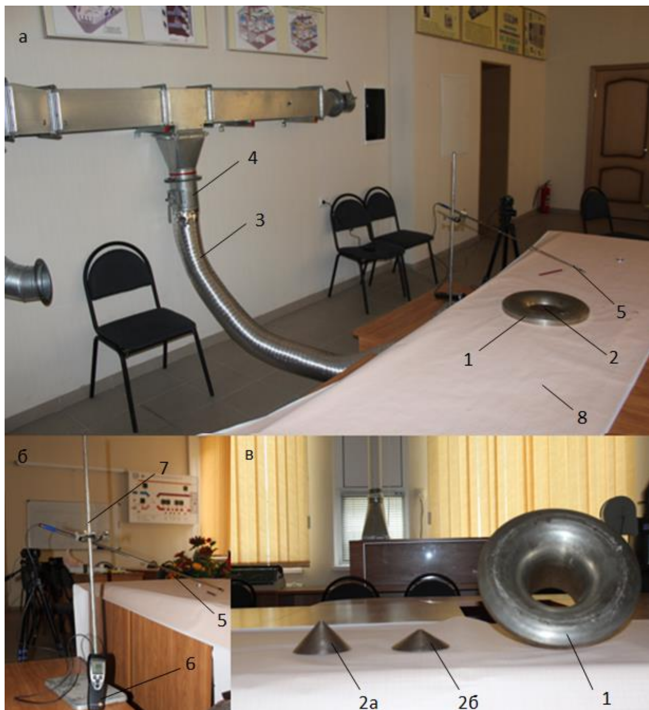
Рис. 5. Экспериментальная установка: а) общий вид экспериментальной установки; б) измерительный прибор; в) элементы устройства снижения пылеобразования: 1 – подающий патрубок с тороидальной поверхностью; 2 – конусный разделитель потока: а – с высотой 60 мм, б – с высотой 40 мм; 3 – воздуховод вентиляционной сети; 4 – воздушный регулирующий клапан; 5 – измерительный зонд; 6 – термоанемометр; 7 – штатив; 8 – координатная сетка
