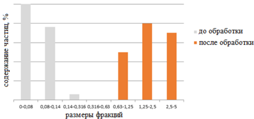
Рис. 9. Результаты измельчения глины, n = 2920 об/мин
